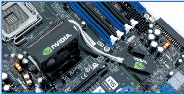
Южный мост nForce 680i SLI греется сильно, так что стоит сразу установить вентилятор.
